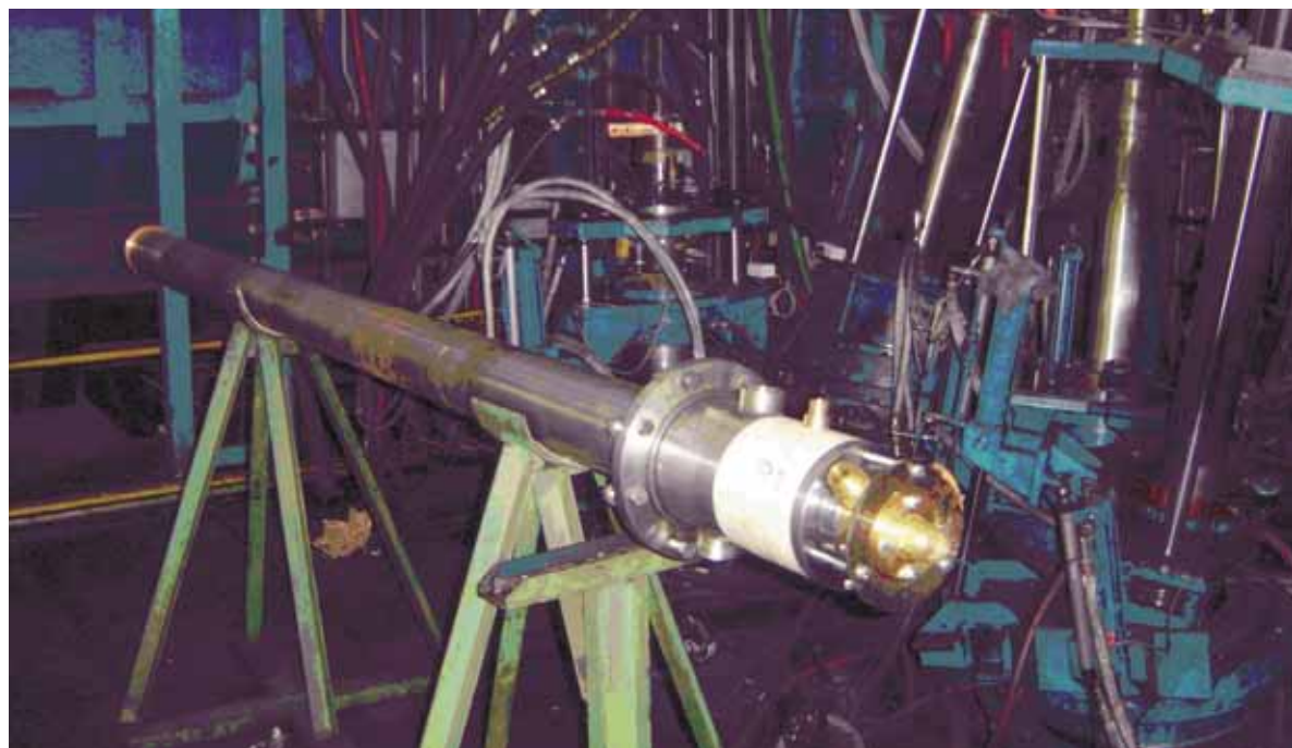
Внедренный на предприятиях России плазмотрон для переплава отходов производства титана. Мощность – до 1 МВт, ток дуги – до 3000 А, газ – гелий, ресурс электрода – не менее 200 часов
